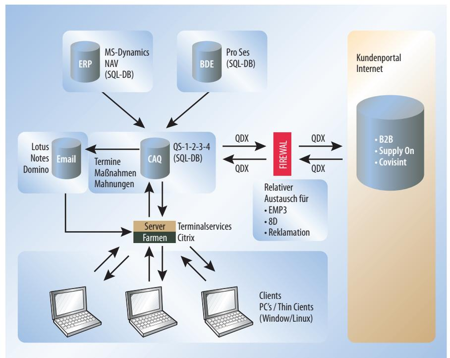
**Bild 1.** Der Austausch qualitätsrelevanter Daten erfolgt bei Pöppelmann über eine Firewall, um die sensiblen Informationen zu schützen.
